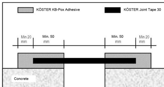
Толщина слоя приблизительно 2 мм. Непосредственно после нанесения клея укладывается шовная лента и прижимается прижимным валиком или другим подходящим инструментом. Необходимо обеспечить сплошной контакт ленты клеєм. В дальнейшем наносится второй слой KÖSTER KB-Pox Adhesive поверх шовной ленты такой же шириной как и первый слой. После нанесения в течении 24 часов защитить от воды, дождя и температур ниже +5 °С. Механические нагрузки недопустимы в течении 48 часов.
